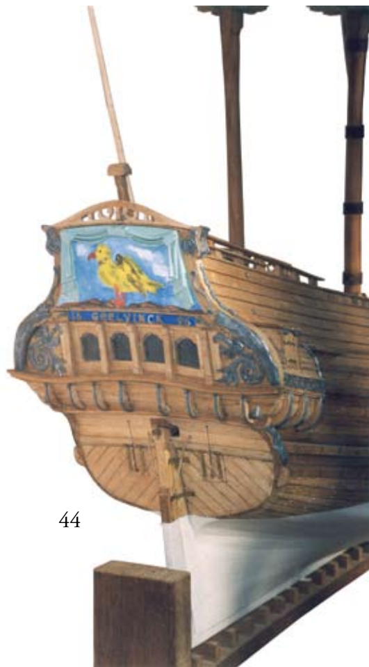
Foto 43 Met de bak (forecastle) en kampagne voltooid, heeft het schip in zijaanzicht haar definitieve vorm gekregen. De ondermasten van fokkemast, grootemast en bezaansmast staan er in en daarop zijn de marsen met de stengen (de verlengde stukken van de masten) geplaatst.
