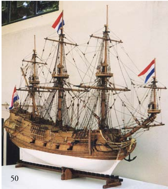
Foto 50 Het model nog eens aan stuurboord gezien. Bakboords-anker hangt onder bakboords- kraanbalk, maar is, in tegenstelling tot stuurboords-anker, (nog) niet tegen de zij gesjord. Achter stuurboords-anker ziet men stuurboords-reserve-anker dat onder de rust van het fokkewant gesjord is, met de zware houten ankerstok verticaal goed in zicht. (Foto 53 toont dat aan bakboord ook zo'n reserve anker hangt.)
