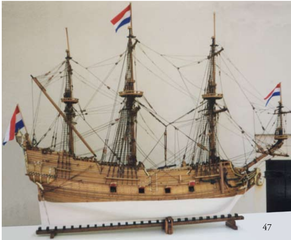
Foto 47 Het voltooid model is voor Museum Tromp's Huys gearriveerd, en staat voor de 16de/17de eeuwse voorgevel daarvan. Het tuig is compleet, met de raas op hun plaatsen en de bezaansroede aan de bezaansmast. (Terwijl de fokkemast en de grootemast dwarsgetuigd zijn, d.w.z. met raas, is de bezaansmast langsetuigd met een latijnzeil, hoewel de bezaansteng ook weer een raazeil kan voeren.) De geschutspoorten staan open en de kanonnen zijn geplaatst. Stuurboords anker hangt onder stuurboords kraanbalk (zie bij de foto's 38 en 40) en is tegen de zij gesjord, zoals dat op zee altijd het geval was.
