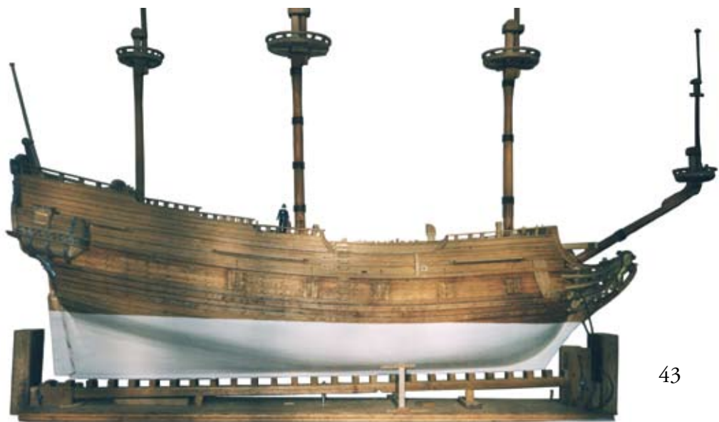
Foto 43 Met de bak (forecastle) en kampagne voltooid, heeft het schip in zijaanzicht haar definitieve vorm gekregen. De ondermasten van fokkemast, grootemast en bezaansmast staan er in en daarop zijn de marsen met de stengen (de verlengde stukken van de masten) geplaatst.
