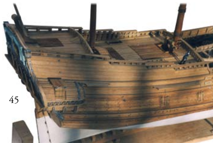
Foto 45 Het achterschip waar de kampagne- en kajuitdekken geheel zijn gelegd en rond die dekken zijn de open hekwerken, de verschansing (waarvoor ook de woorden gillingen, rogboorden of rockgang werden gebruikt), met daarop de reling, aangebracht.
